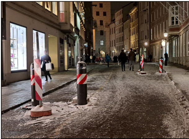
Abbildung 3: Oktablocke als mobile, statische Sperr-einrichtung
